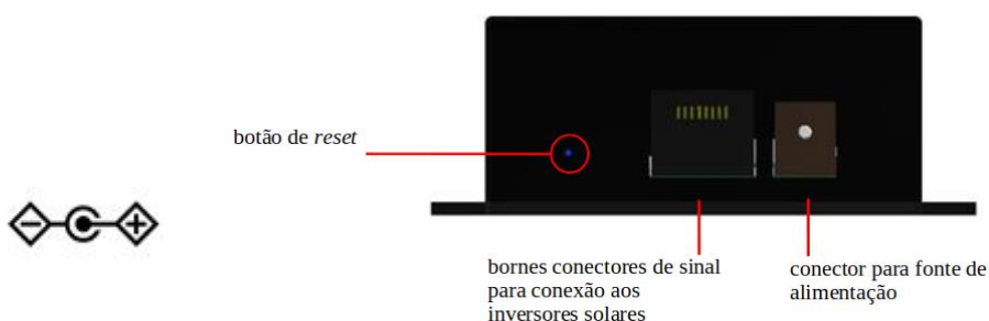
Figura 8 – Conectores e botão do WCD-ED100 (Face frontal)
