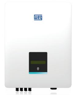
Os inversores SIW400G de 12 a 25kW contam com alta eficiência, 2 rastreadores MPPT, e grande faixa de tensão operacional. Possuem protetores de surto integrados tipo II e grau de proteção IP65. Contam também com a topologia *Fuseless* (sem fusíveis), que reduz a quantidade e os custos de manutenção.
